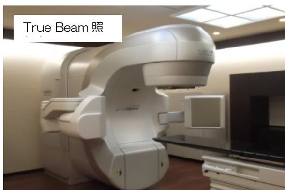
静岡がんセンターの放射線治療で使用するリニアック装置は、開院時(2002年9月)に2台、2005年に1台を追加設置して3台体制で治療を行ってまいりましたが、初期導入の1台を更新し、国内で2番目の導入となる最新機種(True Beam/Varian社製)に入れ替えました。高精度の本装置は、病巣が脳・脊髄、肺、消化管などの重要な臓器に接しているために照射範囲の設定が難しい症例や、周辺組織への影響を考慮して十分な線量を照射出来ないような症例に対して、より正確な照射が可能になります。また、従来の装置に比べて最大4倍の高出力の照射が可能となるため、治
